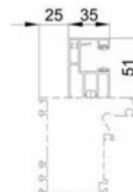
A 73 eingerückte Alu-Führungsschiene
