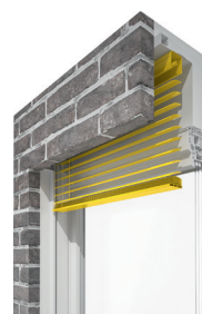
Vnější žaluzie ve variantě do fasád s obkladem
