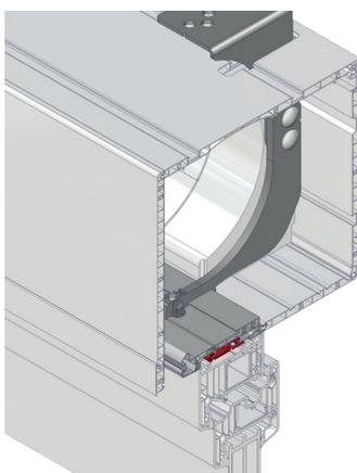
Die mehrteilige Statikkonsole sorgt zusammen mit dem Spezialverstärkungseisen HST für eine zusätzliche Aussteifung des Blendrahmens. Je nach auftretender Windlast können mehrere Statikkonsolen empfohlen sein. Grundsätzlich empfehlen wir ab 2200 bzw. 2450 mm Elementbreite sowie bei Stulpfenstern und -türen den Einsatz von Statikkonsolen. Je nach Einbausituation können auch schon bei geringeren Elementbreiten Statikkonsolen notwendig sein.
