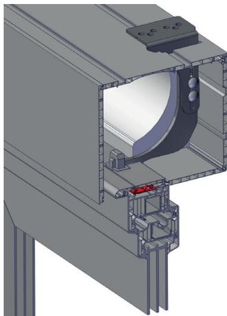
Die mehrteilige Statikkonsole sorgt zusammen mit dem Spezialverstärkungseisen HST für eine zusätzliche Aussteifung des Blendrahmens. Je nach auftretender Windlast können mehrere Statikkonsolen empfohlen sein. Grundsätzlich empfehlen wir ab 2200 bzw. 2450 mm Elementbreite sowie bei Stulpfenstern und -türen den Einsatz von Statikkonsolen. Je nach Einbausituation können auch schon bei geringeren Elementbreiten Statikkonsolen notwendig sein.
