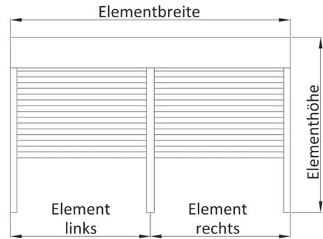
(V3) 2er Kombination mit zwei Einzelführungsschienen (mittig)
