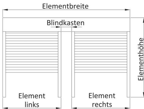
(V4) 3er Kombination mit zwei Doppelführungsschienen
