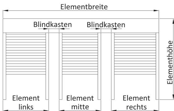
„(V6) 3er Kombination mit einer Doppelführungsschiene und zwei Einzelführungsschienen (mittig)“
