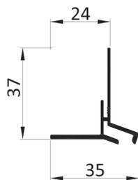
Kastenabschlussprofil für rollgeformten 20° Kasten
