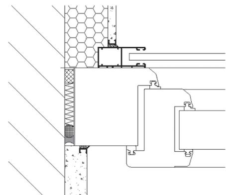
Bild 1 – Anschlussdetail mit Führungsschiene A3 - R
