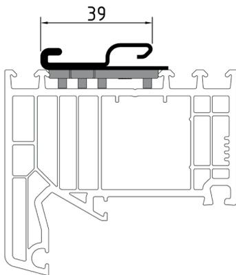
Zum Verstärken des Blendrahmens mit zugehörigen Rast-Adaptern, passend zum Blendrahmenprofil.
