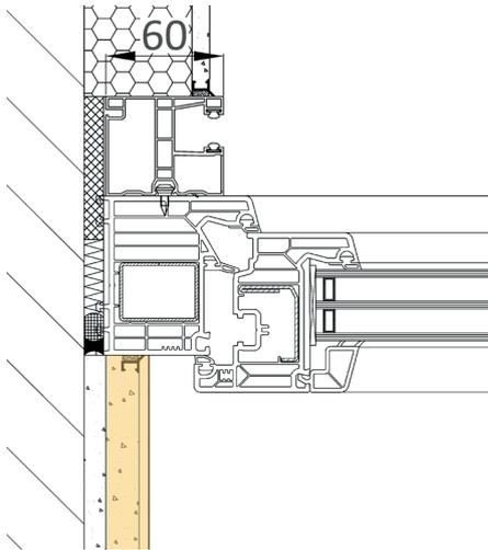
Die Führungsschiene kann komplett eingeputzt werden.
