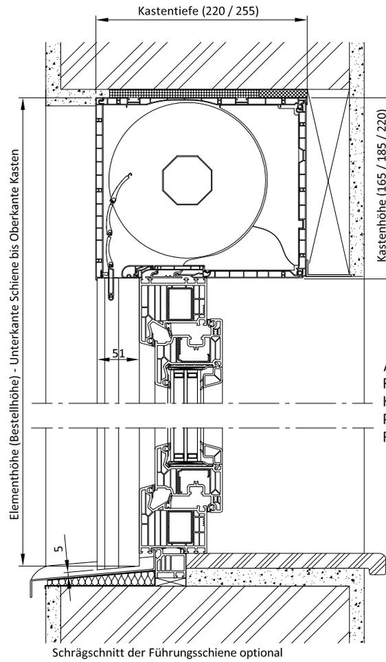
Schrängschnitt der Führungsschiene optional
