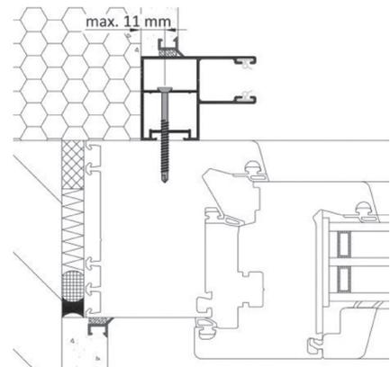
Vom Stuckateur ist sicherzustellen, dass die anzubringende Anputzleiste idealerweise eine durchgehende Kontaktfläche aufweist. Die flachen Abdeckkappen werden vollständig überdeckt (Bild 4). Der seitliche Putzfries sollte mind. 17 mm betragen.
