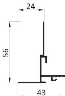
Kastenabschlussprofil für rollgeformten 90° Kasten
