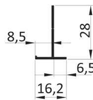
Kastenabschlussprofil für stranggepressten Kasten 20° und 90°
