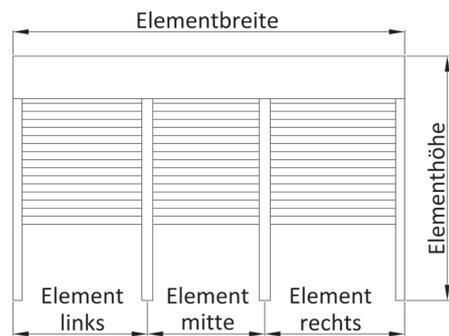
(V5) 3er Kombination mit Einzelführungsschienen
