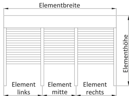
(V5) 3er Kombination mit vier Einzelführungsschienen (mittig)
