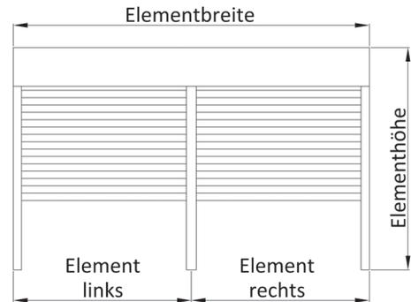
(V3) 2er Kombination mit zwei Einzelführungsschienen (mittig)
