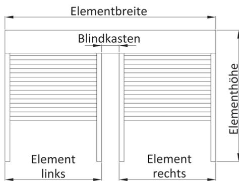
(V4) 3er Kombination mit zwei Doppelführungsschienen
