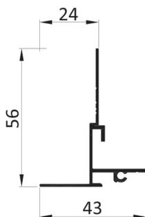
Kastenabschlussprofil für rollgeformten 90° Kasten
