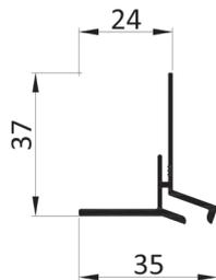
Kastenabschlussprofil für rollgeformten 20° Kasten
