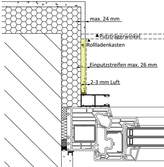
Beim Einputzen der Führungsschiene muss die Revisionsblende getrennt werden.
