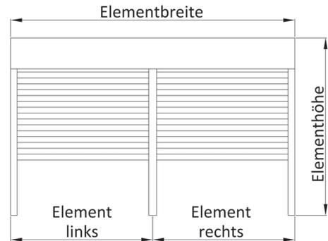
(V3) 2er Kombination mit Einzelführungsschienen
