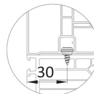
Bei der Montage werden drei Stecknippel pro Meter Führungsschiene verschraubt.
