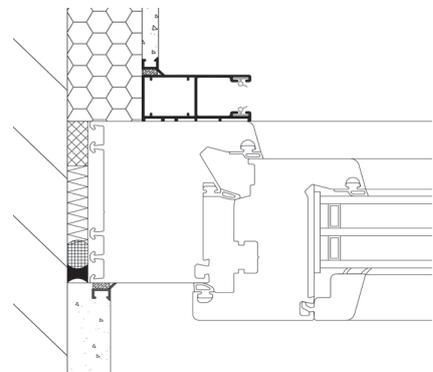
Werden die Führungsschienen am Fensterrahmen mit Schrauben befestigt, so ist darauf zu achten, dass die Stufenbohrung max. 11 mm vom Führungsschienenrand gesetzt wird (Bild 3).
