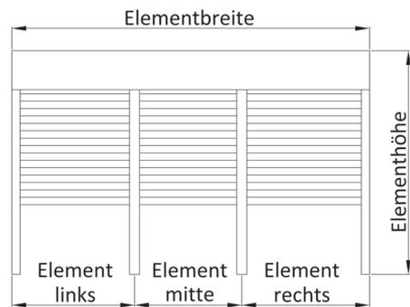
(V5) 3er Kombination mit vier Einzelführungsschienen (mittig)
