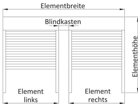
(V4) 3er Kombination mit zwei Doppelführungsschienen
