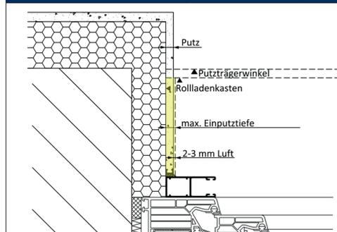
Bei Putzträgerelementen ist ein beidseitiger Blendschnitt zur problemlosen Demontage der Revisionsblende im Reparaturfall zwingend erforderlich. Die Trennung der Revisionsblende erfolgt an den Innenkanten der Führungsschienen.
