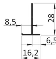
Kastenabschlussprofil für stranggepressten Kasten 20° und 90°
