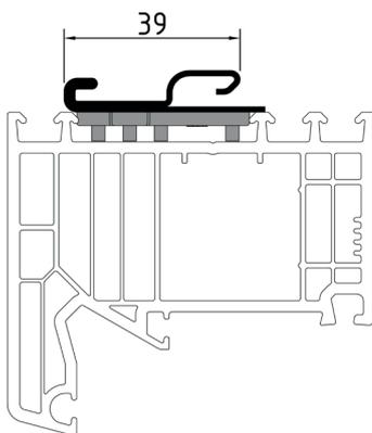
Zum Verstärken des Blendrahmens mit zugehörigen Rast-Adaptoren, passend zum Blendrahmenprofil.
