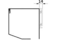
L'élargissement du caisson est nécessaire et déplace le caisson de 14 mm vers l'avant.
